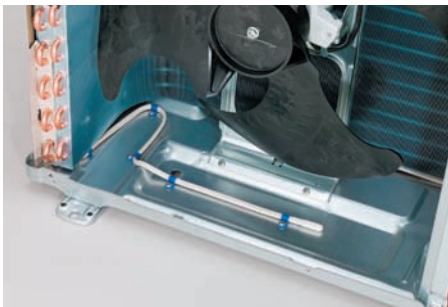
Topný kabel v prostoru kondenzační vany bílé barvy zabraňuje v zimě zamrznutí kondenzátu.
